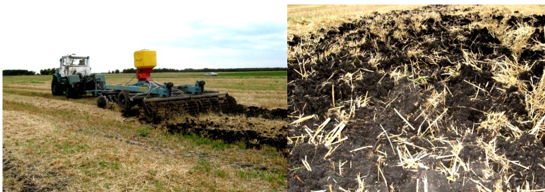
Рис. 2. Дискование почвы бороной БДВП-3,6
