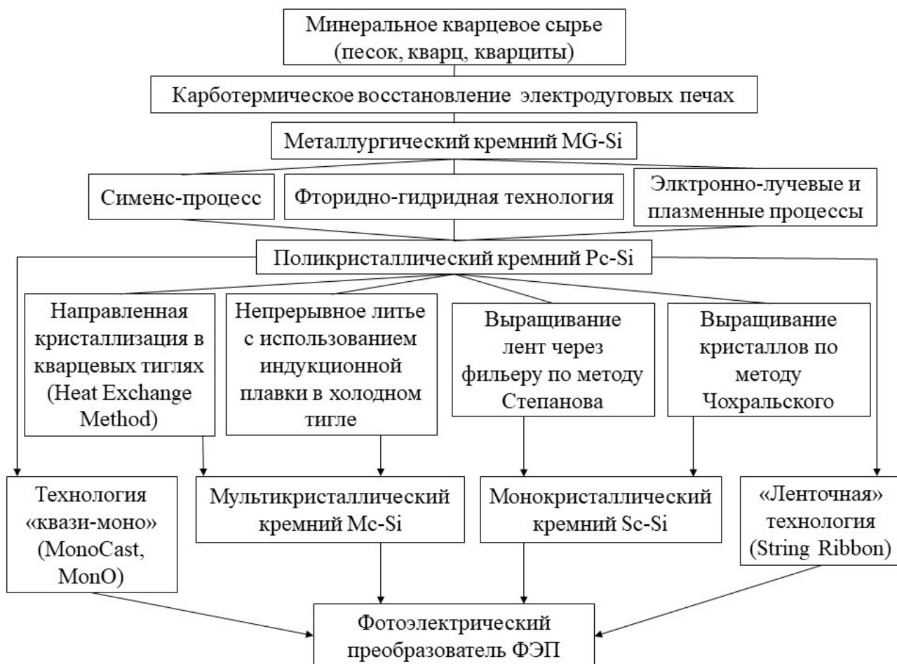
Рис. 3. Блок-схема основных промышленных технологий производства кремния для ФЭП
