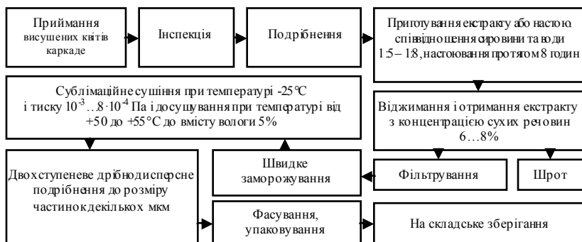
Рисунок – Принципова технологічна схема виробництва антоціанових добавок-барвників із квітів каркаде з використанням екстракції, заморожування та сублімаційного сушіння
