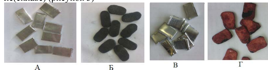
Рисунок 3. Фотографии раздробленного алюминия (ГОСТ 18482-79) до (А, В) и после (Б, Г) контакта с реакционной смесью, содержащей \text{CoCl}_2 (Б) и \text{CuCl}_2 (Г)
