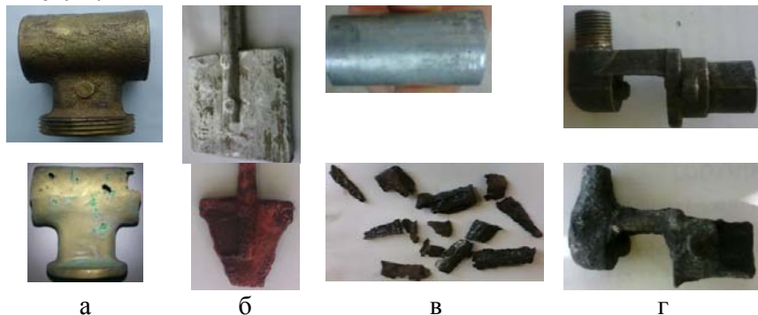
Рисунок 2. Разрушение элементов технологического оборудования из медьсодержащих материалов (бронзы (а) через 18 часов, алюминия (б, в) через 7 (б) и 30 (в) часов и дюралюминия (г) (24 часа) контакта с водными растворами азотной (а) и муравьиной (б-г) кислот
