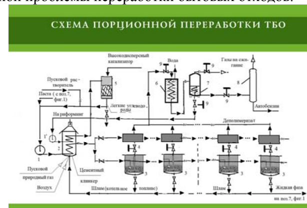
Рисунок 2. Схема порционной переработки ТБО
