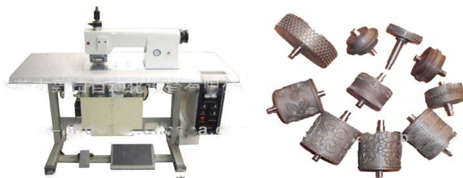
Рис. 1. Зовнішній вигляд типової сучасної УЗЗ- швейної машини для виконання з'єднувальних швів (зліва) і робочі з'ємні ролики для УЗЗ- обладнання для виготовлення різноманітних оздоблюючих елементів.
