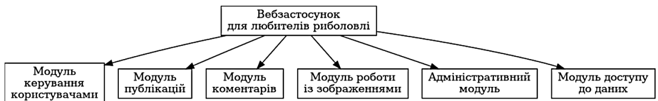
Рисунок 3.2. Структура основних модулів вебзастосунку
