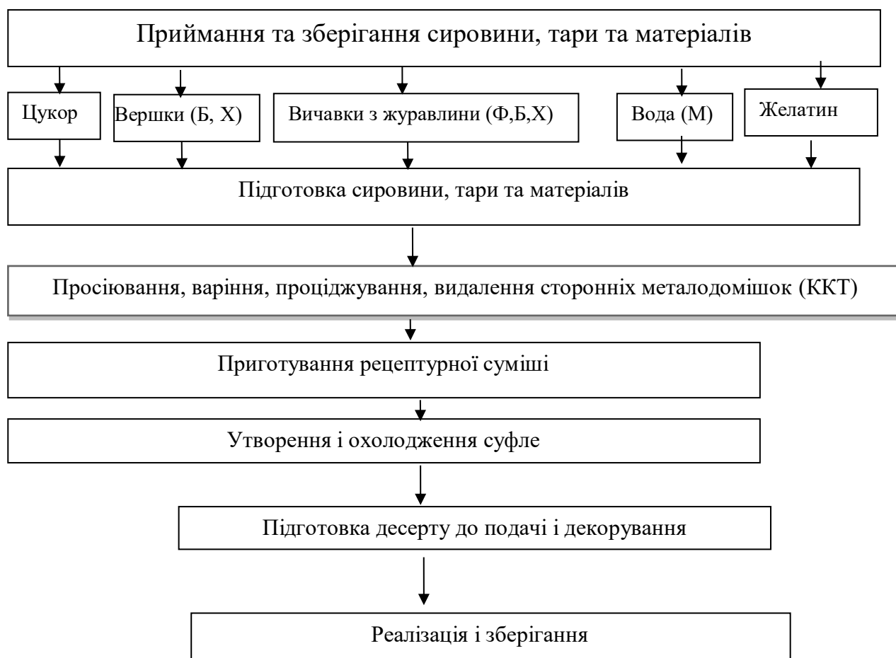
Рисунок 4.11 - Блок-схема з виробництва суфле з використанням желуючого соку з вичавок журавлини
