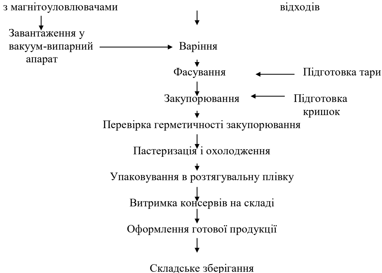
Рисунок 2.2 - Технологічна схема з виробництва консервів «Соус яблучний»
