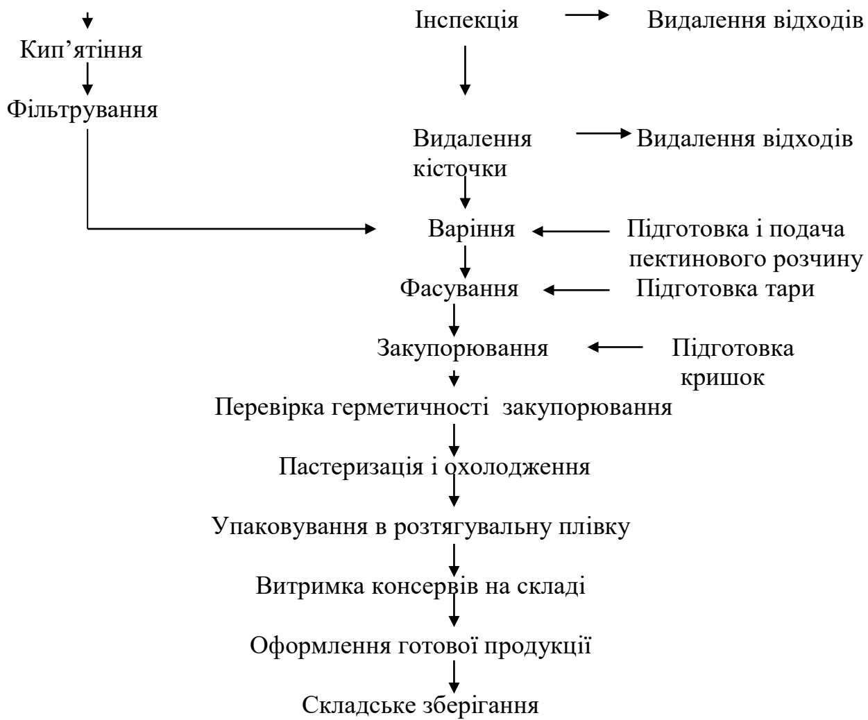
Рисунок 2.1 - Технологічна схема з виробництва консервів «Конфітюр з кісточкових»
