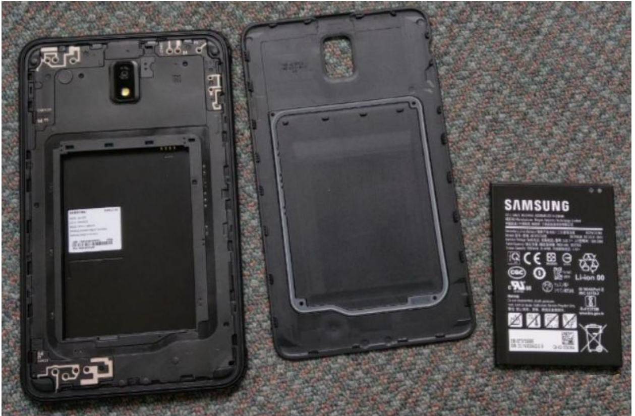
Рисунок 2.2 Світлина планшета Samsung Galaxy Tab Active3 у розібраному вигляді для заміни батареї (світлина взята з сайту Eprice [32])
