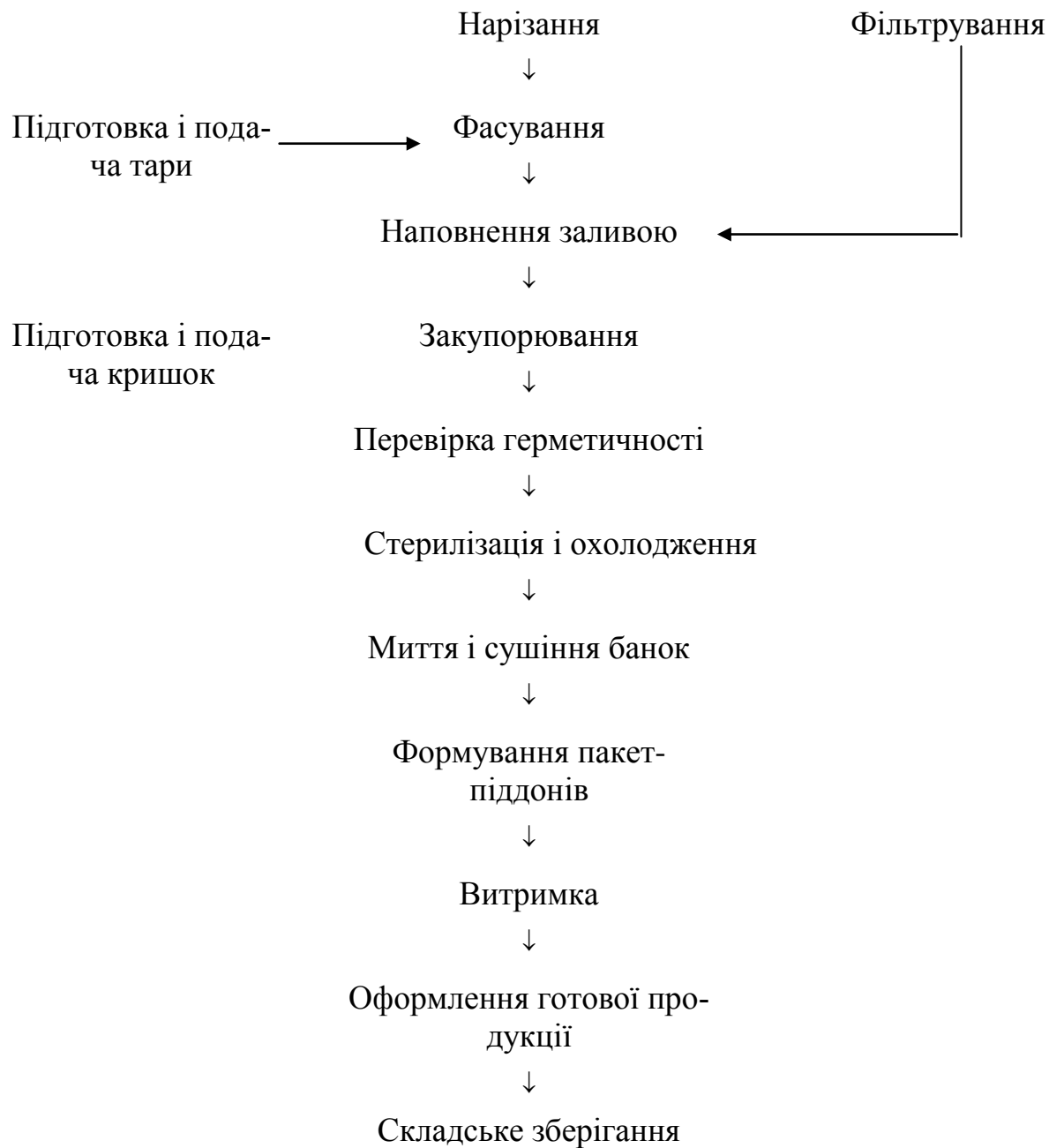
Рисунок 2.2 – Технологічна схема виробництва консервів «Буряк гарнірний»
