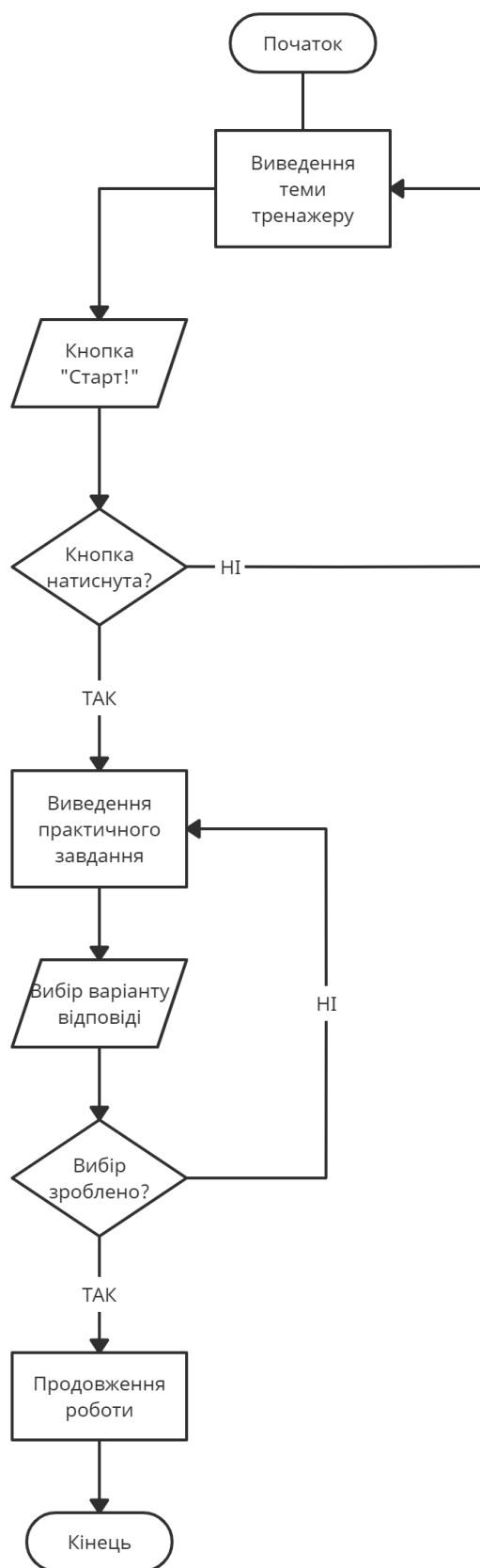
Рисунок 3.5 – Блок-схема алгоритму роботи тренажера
