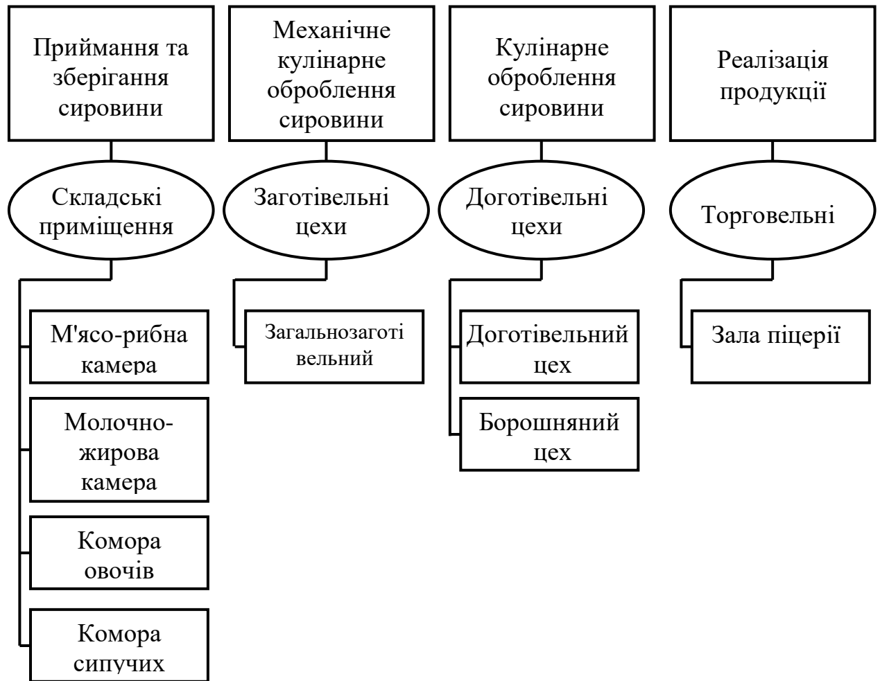
Рис. 2.2. Структурно-технологічна схема підприємства
